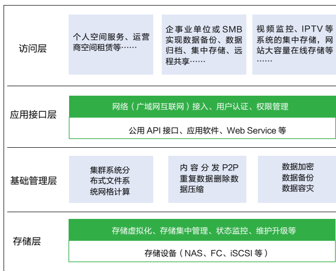
图1 云存储系统的结构模型
