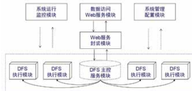
图 4 分布式存储管理系统模块组成
